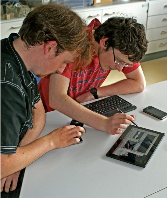
Abb. 3: Studenten untersuchen das Phänomen der Schwebung. Zwei Smartphones dienen als Schallquellen. Mit dem Tablet-PC werden diese akustischen Signale aufgenommen, dargestellt und verarbeitet.
