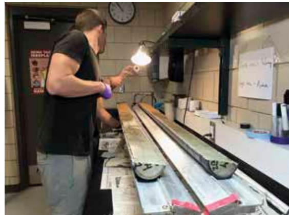
Längs aufgeschnitten: der Bohrkern im Labor
