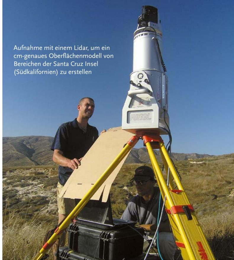
Aufnahme mit einem Lidar, um ein cm-genaues Oberflächenmodell von Bereichen der Santa Cruz Insel (Südkalifornien) zu erstellen
