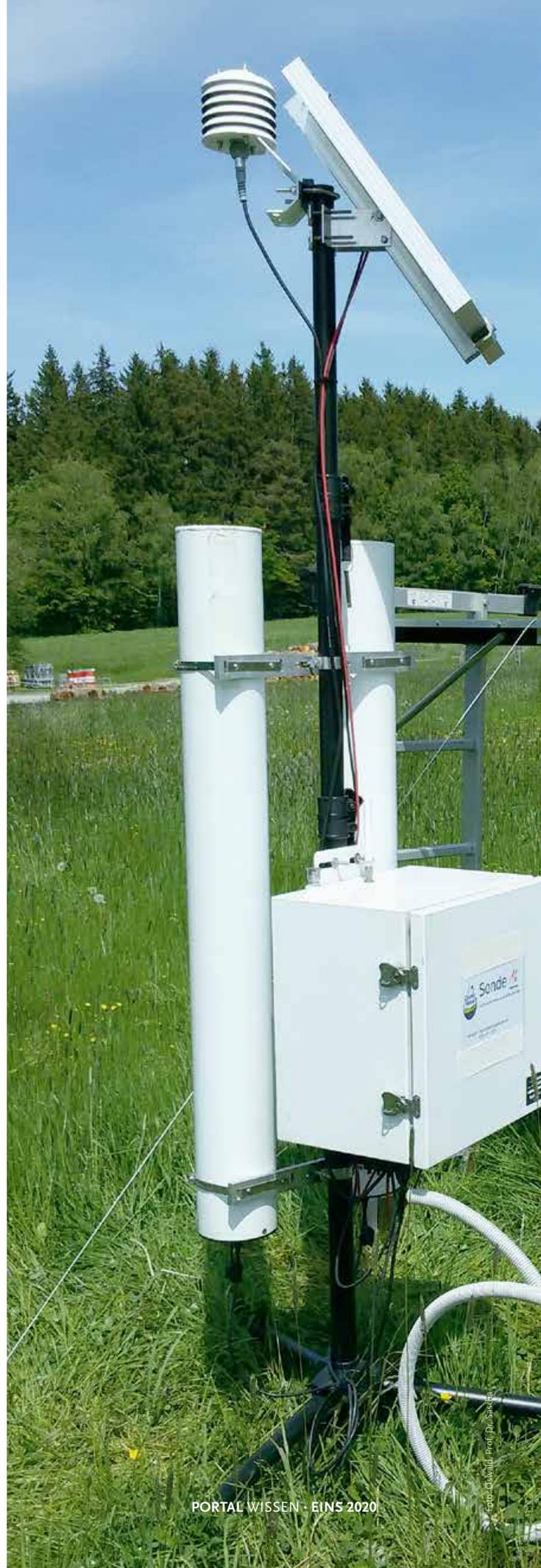
Nichtinvasive Cosmic-Ray Neutron Sensing (CRNS)-Sonde auf einer Wiese bei einer Vergleichsmessung mit Kalibrator
