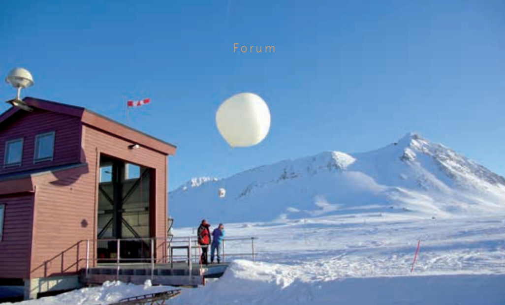
Ozonsondenstart an der Forschungsstation Ny-Ålesund auf Spitzbergen. Foto: J. Graeser
