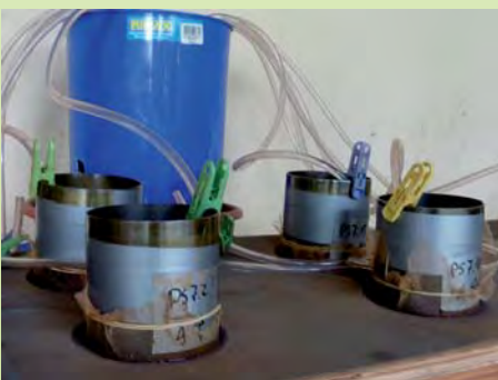
Abb. 2: Messanlage mit Bodenproben
