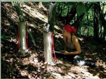
Abb.2: Amoozemeter (Compact Constant Head Permeameter) Messung von Ksat in 12,5 cm und 18,5 cm
