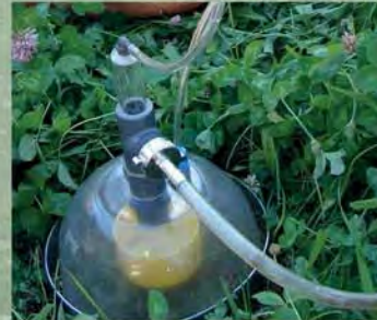
Abb.3: Hauben-Infiltrometer Messung der Infiltrabilität
