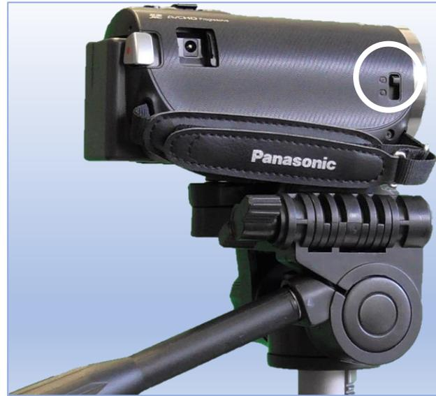
Zum Filmen muss die Blende allerdings geöffnet sein. An der Seite des Camcorders befindet sich ein kleiner Schalter.
