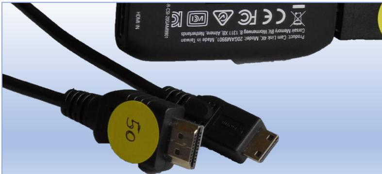
Nun muss das Kabel mit einem HDMI-Stecker an der einen und einem Mini-HDMI-Stecker an der anderen Seite verwendet werden.
