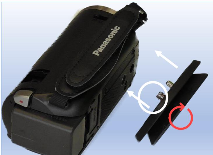
Der kleinere Metallzapfen ohne Gewinde kommt ins äußere Loch.
