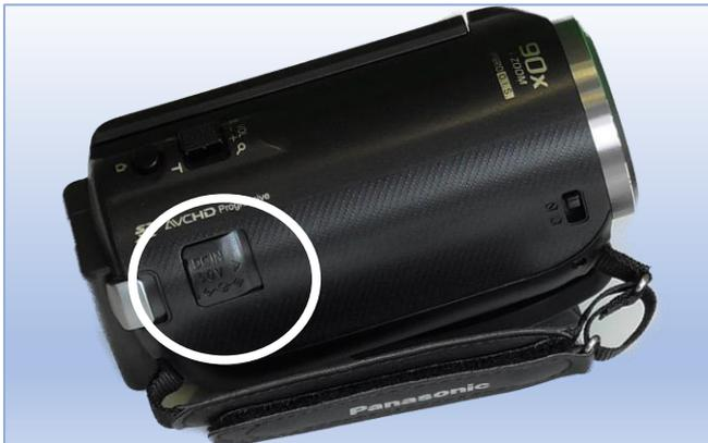
Die Buchse für die Stromzufuhr ist zunächst verdeckt.
