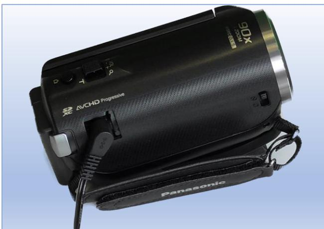
Der Stecker des Netzteils kann nun eingesteckt werden.
