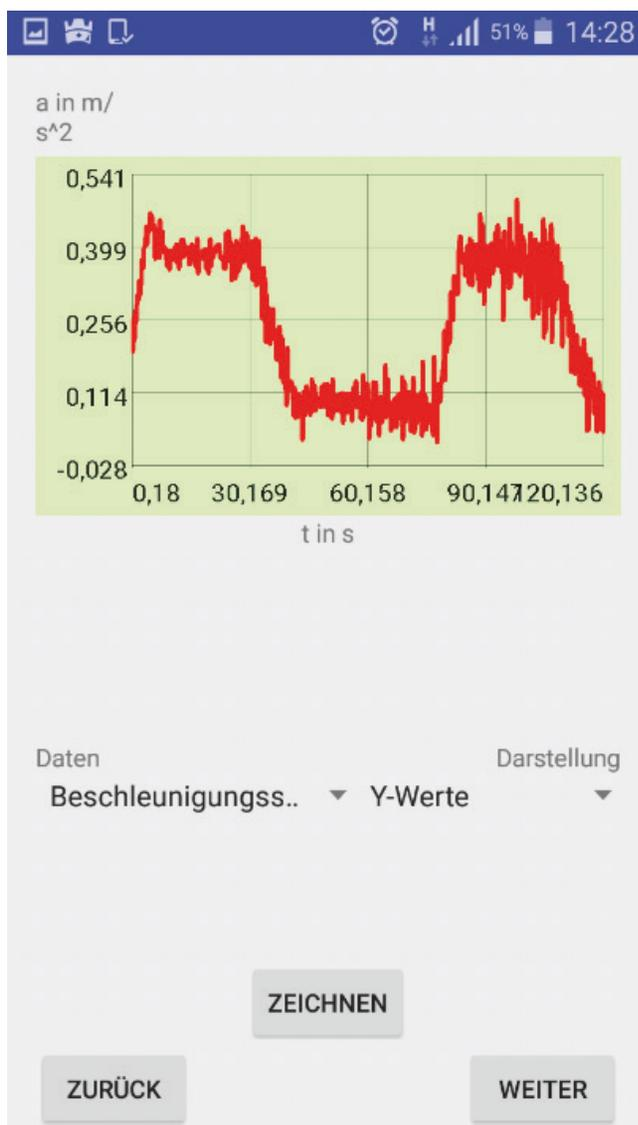
Abb. 3: Die Beschleunigungswerte eines anfahrenden ICEs in Fahrtrichtung sind in einem a-t-Diagramm aufgetragen. Kurz nach dem Anfahren hörte der Zug aufgrund eines zu durchfahrenden Wohngebietes kurzzeitig auf zu beschleunigen.
