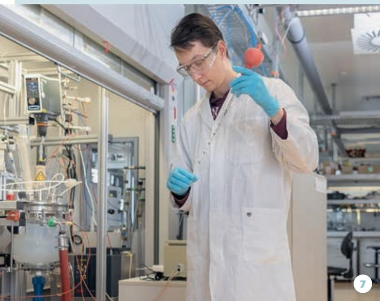
7 Während die Chemikalien in den Reaktor gepumpt werden, entnimmt Aaron Justin Koenig alle fünf Minuten mit einer Glaspipette eine Probe aus der gemischten Lösung. Diese Proben werden für eine andere Technik im Nebenlabor verwendet: die dynamische Lichtstreuung zur Messung der Partikelgrößenverteilung.
