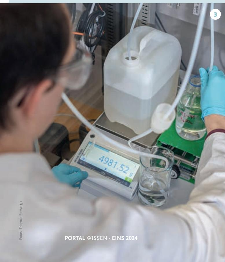
**1** Zunächst wird destilliertes Wasser in einem Sechs-Liter-Glasreaktor auf 80 Grad Celsius aufgeheizt. Die benötigten Chemikalien Schwefelsäure ( $\text{H}_2\text{SO}_4$ ) und Wasserglas ( $\text{Na}_2\text{SiO}_3$ ) werden abgemessen und vorbereitet.
