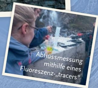
Abflussmessung mithilfe eines Fluoreszenz-„tracers“
