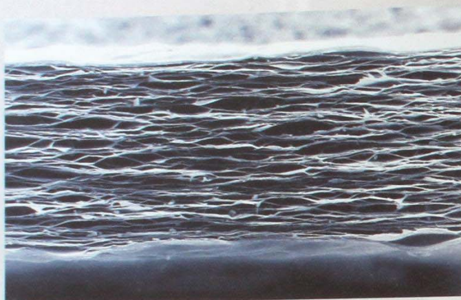
Was hier wie eine verödete Berglandschaft aussieht, ist in Wirklichkeit ein Schnitt durch eine Polymerfolie aus zellulärem Polypropylen.
