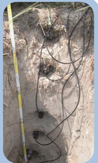
Abb. 3: FDR Sonden im Dünensand, installiert in den Tiefen 10 cm, 30 cm, 60 cm, 80 cm, 100 cm
