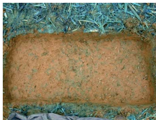
Abb. 6: Horizontales Profil für die Zählung der Makroporen
