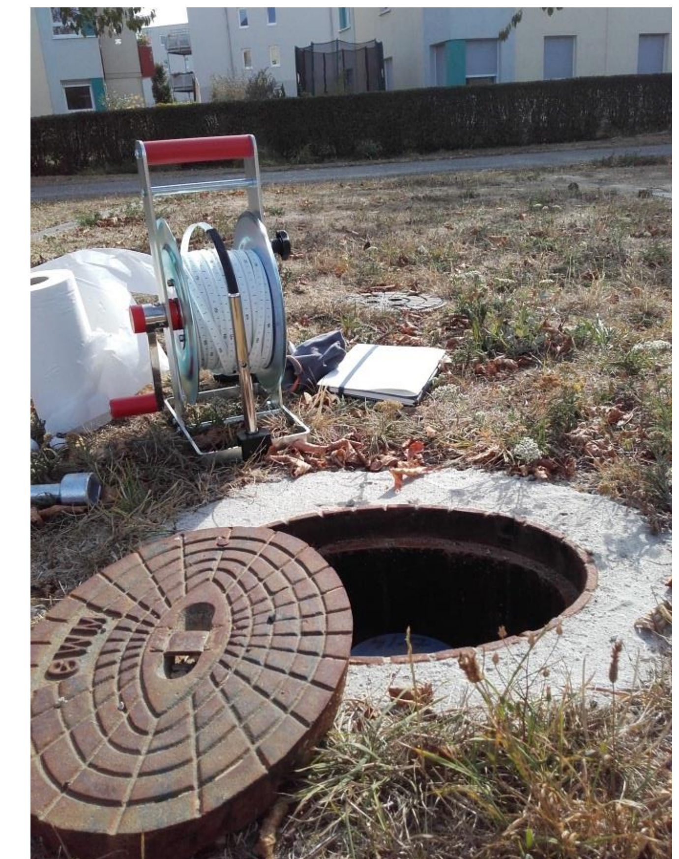
Abb. 6: Beprobung von Grundwassermessstelle
