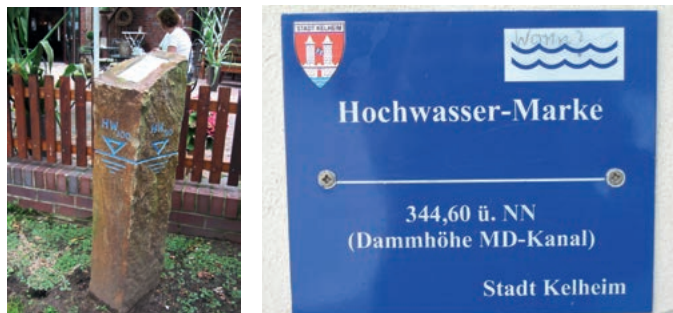
Abb. 5.10: links: Hochwassermarken bei Petershagen an der Weser, die den Wasserstand eines 100-jährlichen Hochwassers anzeigt; rechts: Hochwassermarken in Kelheim an der Donau, die anzeigt, wo das Wasser bei Versagen des Damms stünde (Fotos: A. Thieken).
