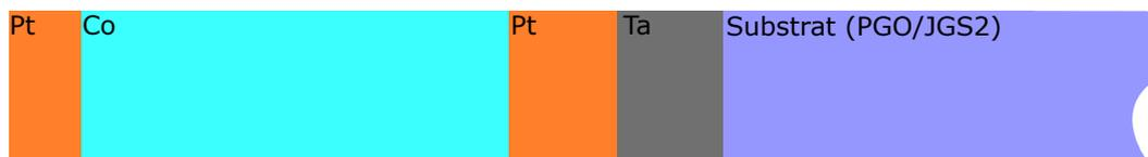
ABBILDUNG 3.1: **Struktur der verwendeten Proben:** Die Abbildung zeigt den schematischen Aufbau der Proben. Die Schichtdicken sind in Tabelle 3.1 aufgelistet.
