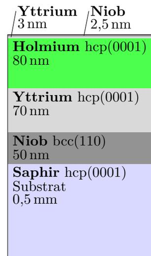
**Abbildung 4.1:** Schematischer Aufbau der für die Experimente genutzten Probe „MBE2057“.
