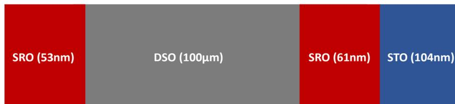
**Abbildung 2.1:** Aufbau der untersuchten Probe. Als Transducer dient auf beiden Seiten eine  $53\text{nm}$  beziehungsweise  $61\text{nm}$  dicke Strontiumruthenatschicht (SRO) auf einem  $100\mu\text{m}$  dicken Dysprosiumscandat-Substrat (DSO). Im Folgenden wird die Seite mit der zusätzlichen  $104\text{nm}$  dicken Strontiumtitanatschicht (STO) als Rückseite der Probe bezeichnet.
