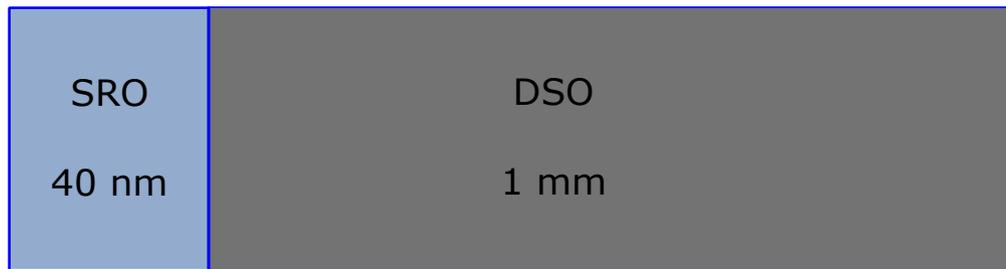
Abbildung 3.5: Aufbau der Probe I. Als Transducer dient hier eine 40 nm breite Strontium-Ruthenat-Schicht (SRO) und als Substrat Dysprosiumscandat (DSO).
