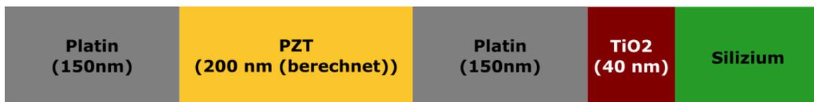
**Abbildung 3.3:** Schematischer Schichtaufbau der untersuchten PZT Probe. Als Substrat dient Silizium auf dem eine 40 nm dicke Schicht Titandioxid aufgebracht ist gefolgt von 150 nm Platin, 200 nm PZT und danach nochmal 150 nm Platin. [24]
