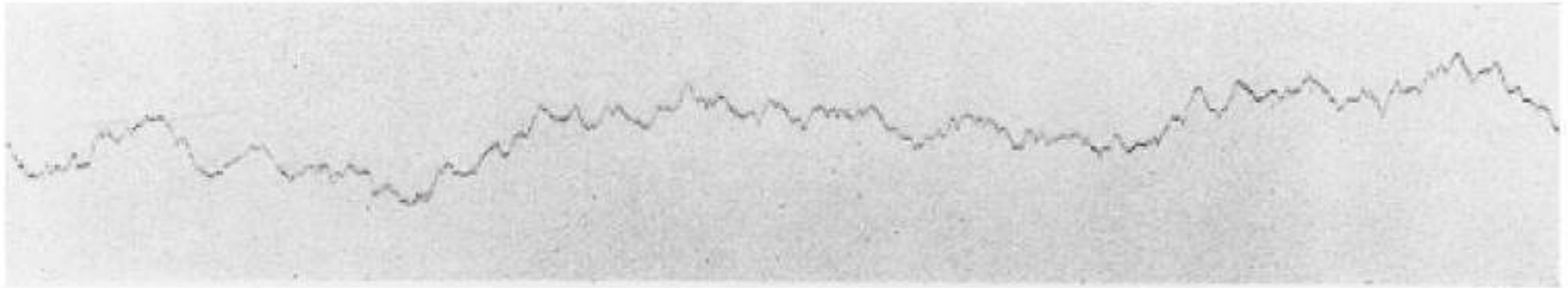
Registrieraufnahme der Brownschen Bewegung (natürliche Größe). Direktionskraft 9,428 \cdot 10^{-9} abs. Einh. Trägheitsmoment: 1 \cdot 10^{-7} abs. Einh. Abstand Spiegel-Kamera: 72,1 cm. Zeitmarke: 30 sec dx = 1 mm. a) Atmosphärendruck. Temperatur 13^{\circ} C
