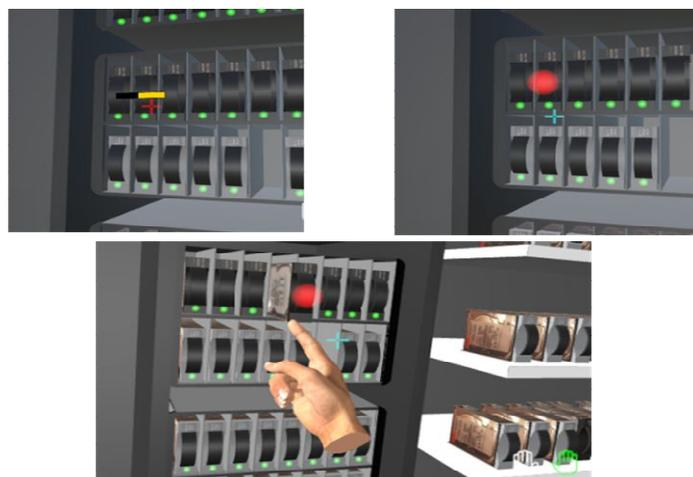
Abb. 5: *Oben*: Festplatten-Selektion über RayCast, *Unten*: "Greif"-Aktion
