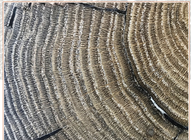
Abb. 9: Querschnitt eines Holzpfiebers der ersten Moselbrücke
