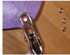
Abbildung 17: Anbringen des Druckknopf mittels der Druckknopfzange
