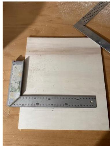
Abbildung 6: Anzeichnen des Schlitzes
