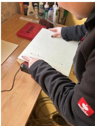
Abbildung 9: Heraussägen des Schlitzes
