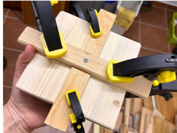
Abbildung 15: Befestigung von Schraubzwingen zum Trocknen
