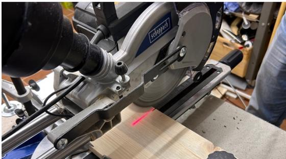
Abbildung 3: Zuschneiden entlang der Markierung
