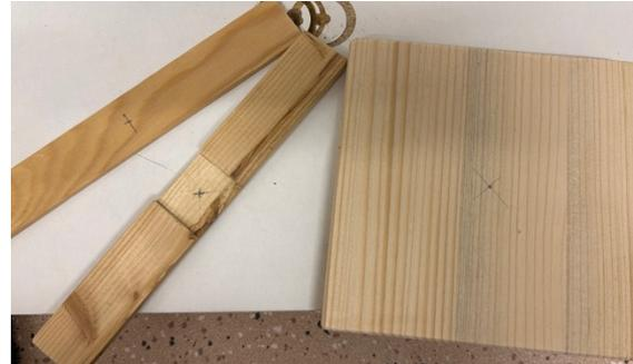
Abbildung 10: Anzeichnen der Mittelpunkte
