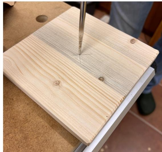
Abbildung 11: Einstechen der angezeichneten Mittelpunkte
