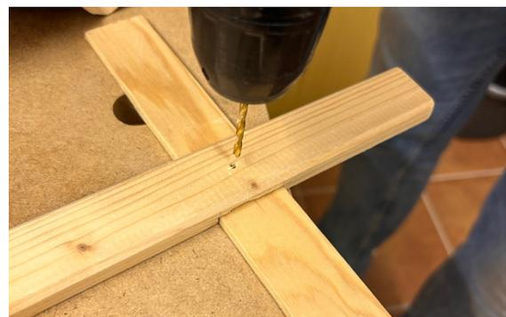
Abbildung 12: Durchbohren der Leisten A (oben) und B (unten)
