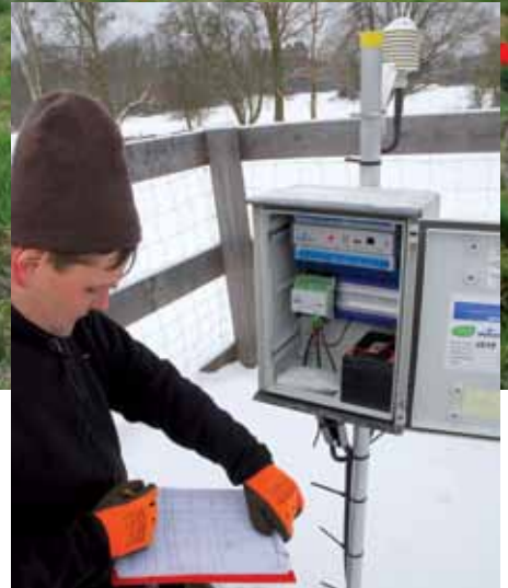
100 Klimastationen im Exploratorium Schorfheide zeichnen ganzjährig Temperatur und Feuchtigkeit im Boden und an der Luft auf.
