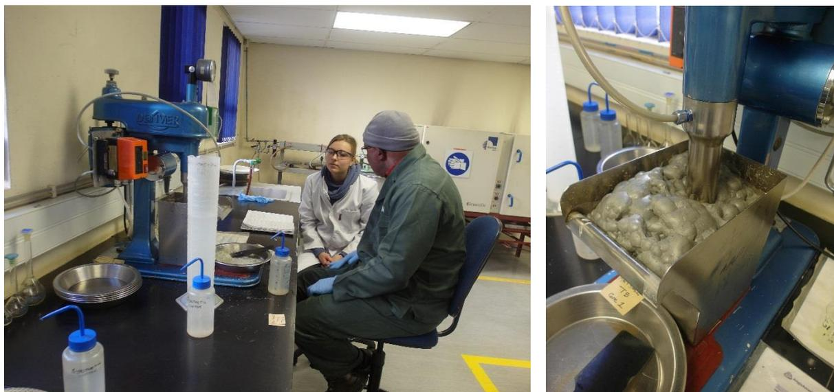
*Einführung in die Arbeit im Flotations-Labor. In der sog. Flotationszelle (detailliert im rechten Bild) wird das zu untersuchende Material abhängig von seiner Herkunft auf eine ganz bestimmte Weise behandelt (flotiert). Es werden verschiedene Konzentrate aufgefangen, die dann chemisch untersucht werden.*
